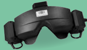
Gafas con cámaras laterales con inserciones de espuma
